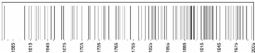
Abb2: Jahrring-basierte Rekonstruktion der Murgangaktivität auf dem Kegel des Ritigraben zwischen AD 1566 und 2005.
